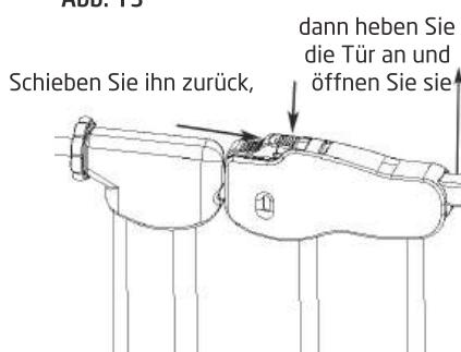
Ihr Gitter ist jetzt installiert. Um das Gitter zu öffnen, schieben Sie den Riegel zurück, bis sich der metallische Sperrstift aus dem Sperrloch im Rahmengehäuse löst, heben das Gitter an und öffnen die Tür, um hindurchzugehen. Siehe Abb. 13. Nachdem Sie durch das Gitter gegangen sind, lassen Sie die Tür los, die dann zurückschwenkt, um sich zu schließen.
